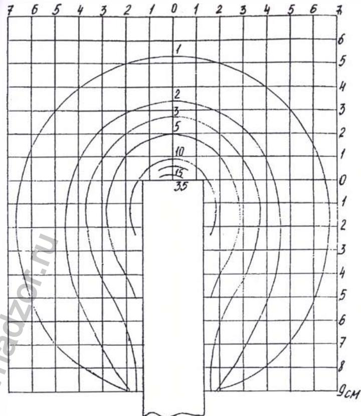
Рисунок 2 – Картина магнитного поля индуктора № 2 (внутриполостного)
