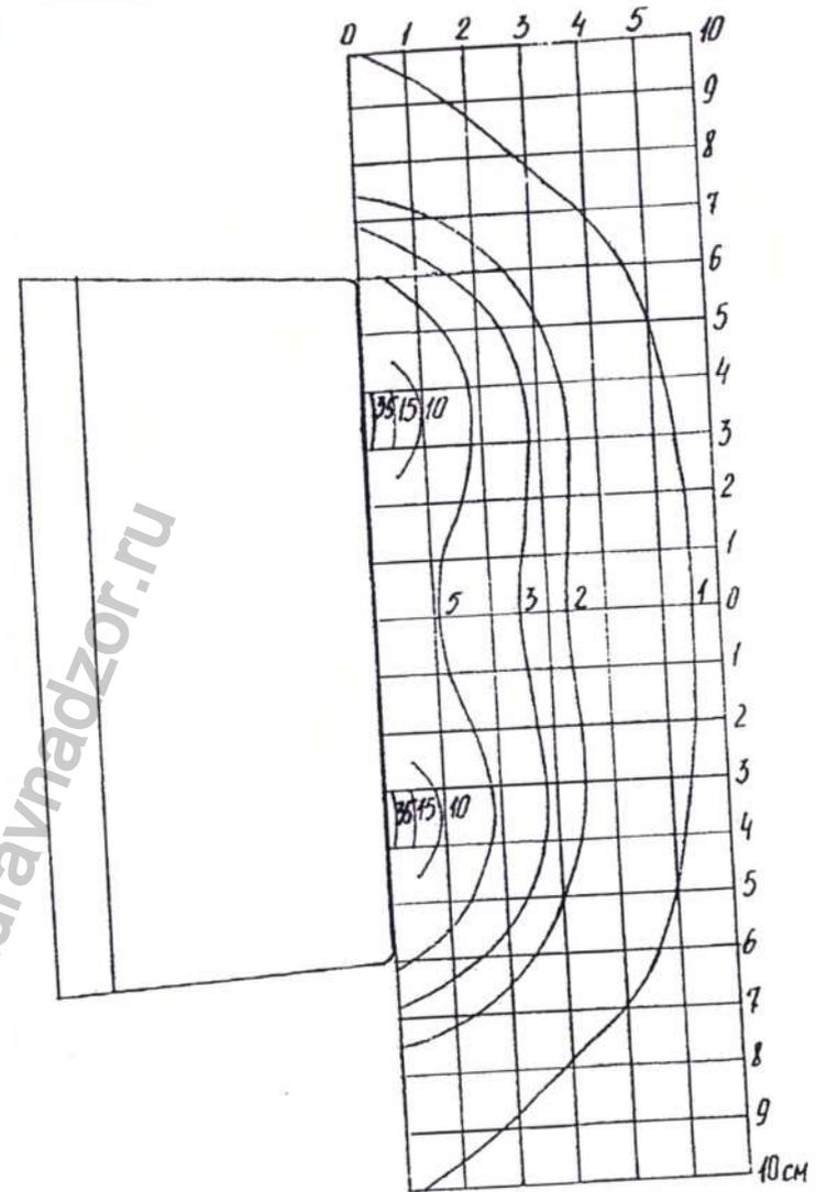
Рисунок 4 – Картина магнитного поля индуктора № 4
